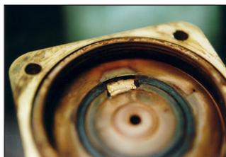
Fremdventil mit defekter Dichtung
