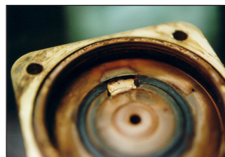
Fremdventil mit defekter Dichtung
